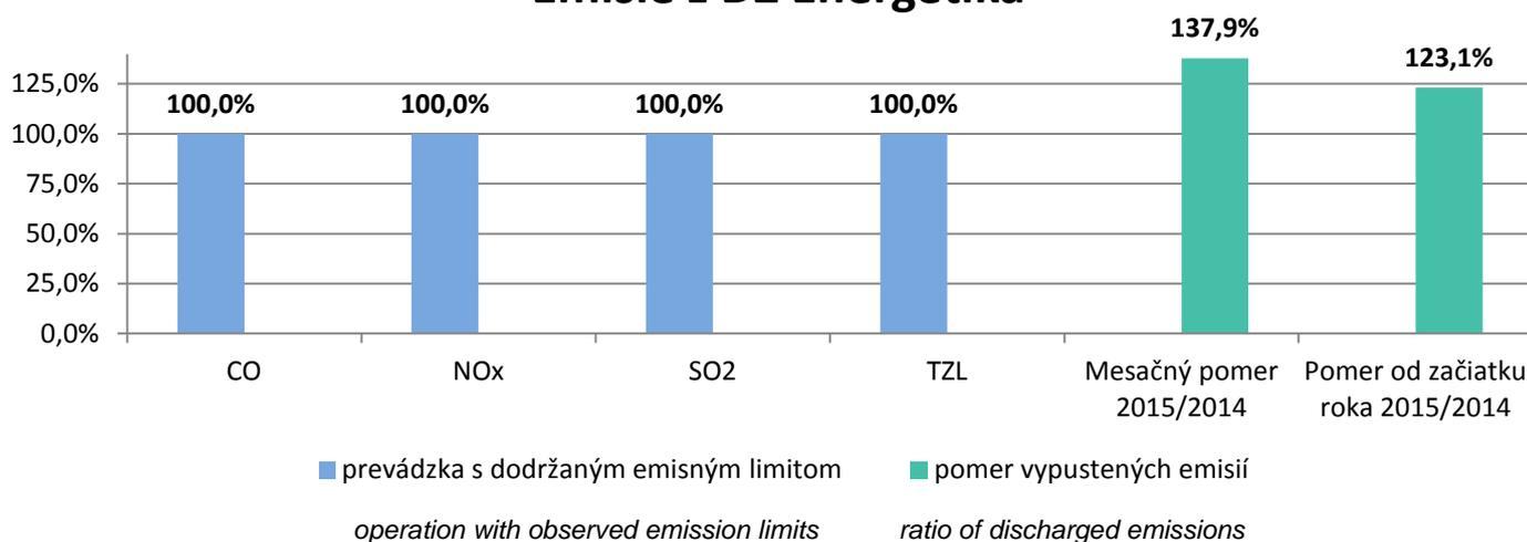
\* - nárast mesačného pomeru emisií voči roku 2014 je spôsobený počtom prevádzkovaných kotlov v danom mesiaci t.j. 2014 päť kotlov a 2015 šesť kotlov /monthly increase of emissions in comparison with 2014 has been caused by operation of 5 boiler in 2014 but in 2015 six boilers have been in operation in the same time
